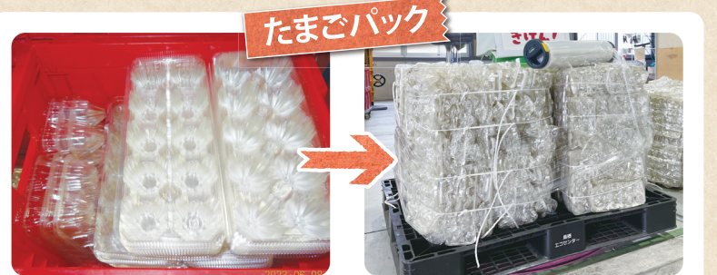
ラベルあり・なしに分別します。汚れているもの・シールが大きいものは除外します。不純物を取り除き、約40kgのかたまりにします。
