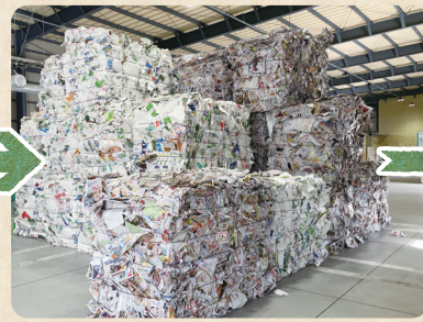
大型のプレス機で圧縮し、ベール（紙のかたまり）にした後、作業場内の定位置に整理します。
