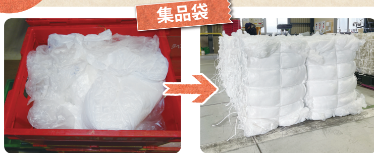
集品袋（配達時に商品が入った袋）が赤いコンテナに入って入荷されます。不純物を取り除き、約30kgのかたまりにします。
